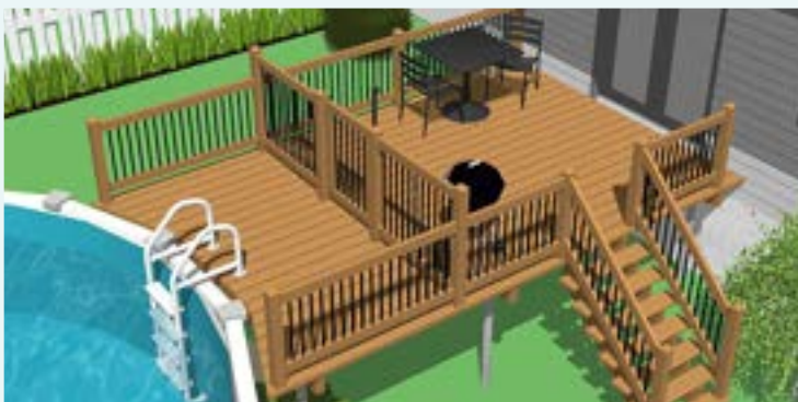
Exemple de terrasse rattachant la piscine à la résidence. La clôture empêchant l'accès à la piscine doit toujours avoir au moins 1,2 m de hauteur.
